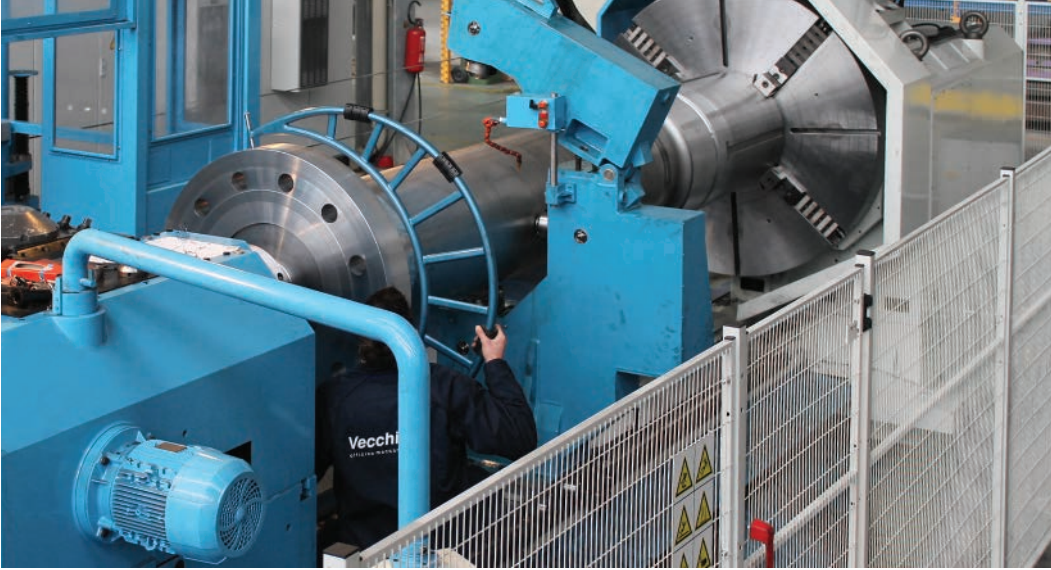
Tornio orizzontale Tacchi dotato di dispositivo di fresatura su torretta. Tacchi horizontal lathe equipped with milling device.
