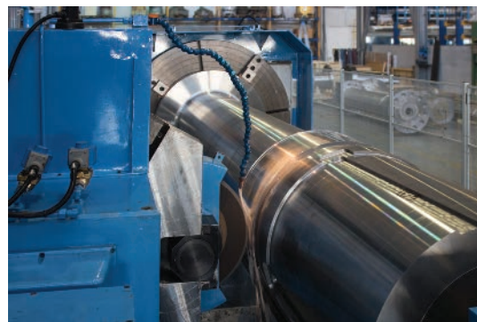
Tornio orizzontale Inse dotato di dispositivo di rettifica. Inse horizontal lathe equipped with grinding device.
